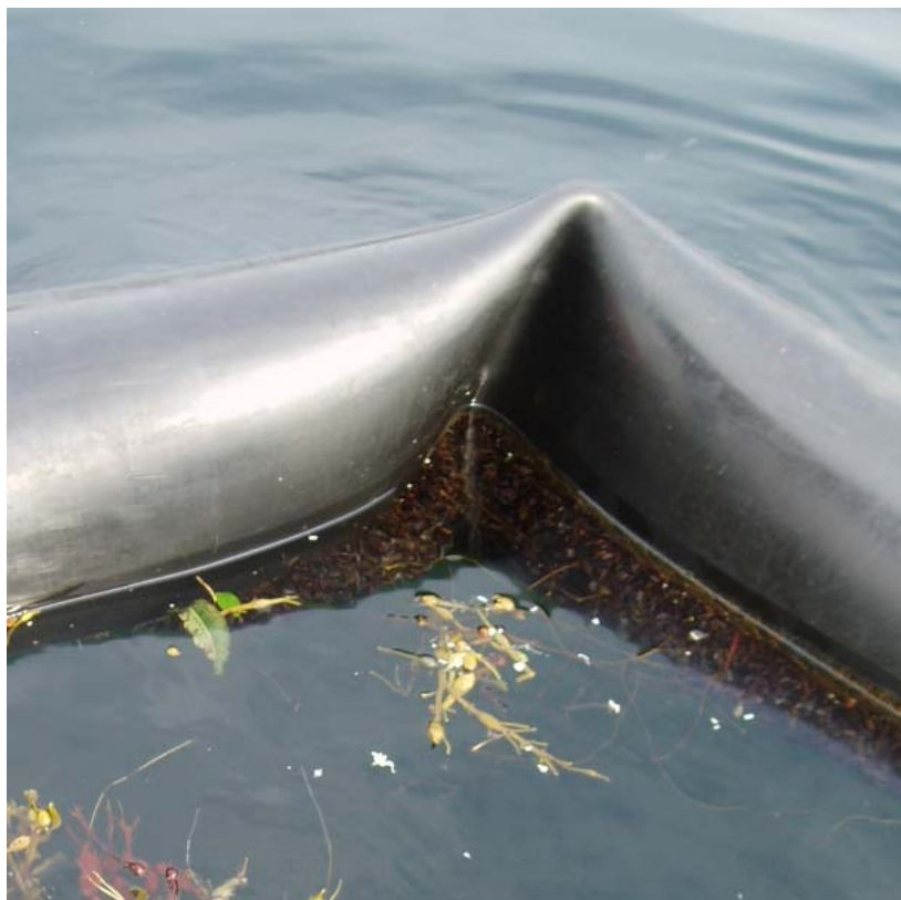
Figur 5 Eksempel på lokalt kollaps av tverrsnitt.
